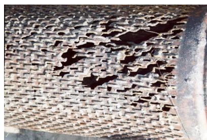
Schlitzverengung/Lochfraß im alten Stahlfilter
